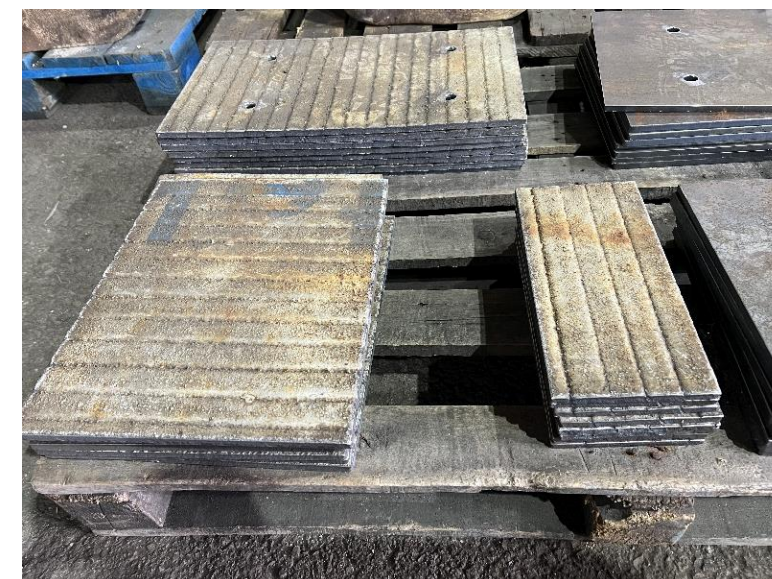
Plazma rezanje, tvrdo navarene ploče, debljina 10 mm
