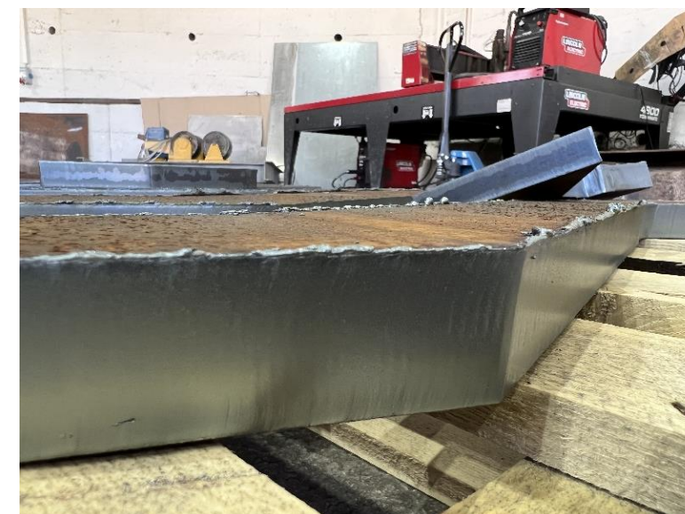
Plazma rezanje, ugljični čelik, debljina 30 mm
