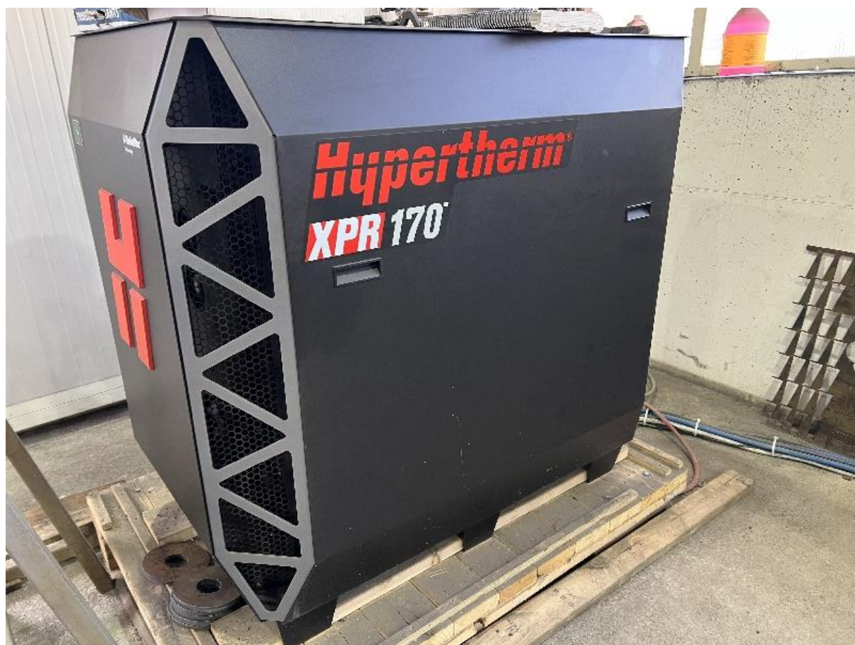
Hypertherm XPR170 izvor struje za plazma rezanje, X-Definition, True Hole, True Bevel tehnologije
