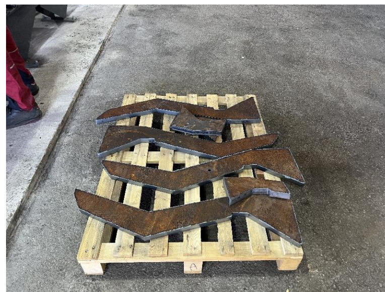
Plazma rezanje, ugljični čelik, debljina 30 mm
