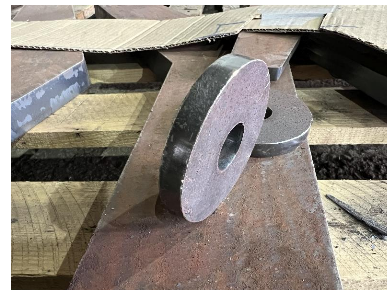
Plazma rezanje, ugljični čelik, debljina 10 mm
