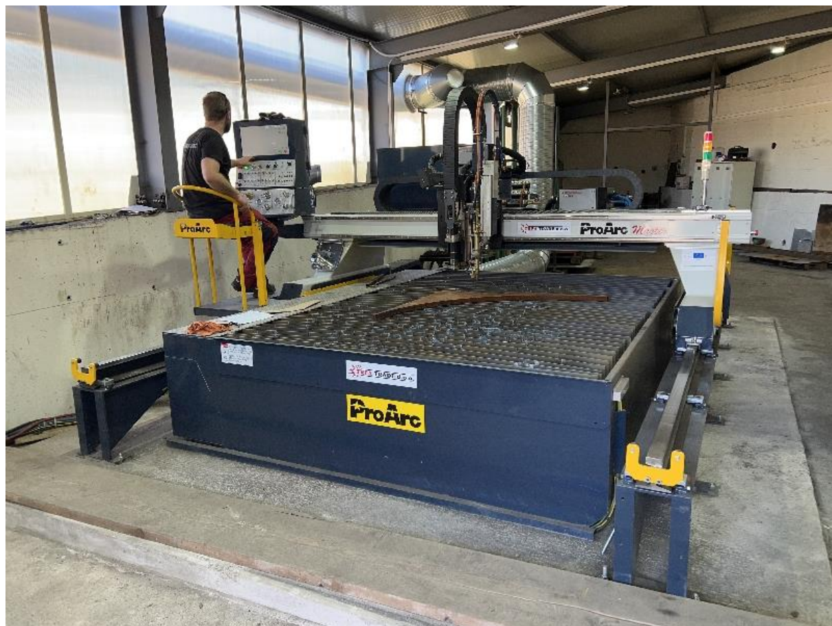
ProArc Master stol za rezanje max. veličine lima 2000x3000 mm, plazma + plinsko rezanje
